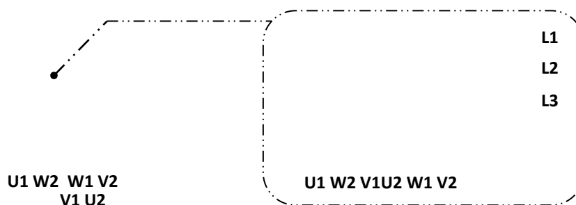
Рисунок 20: Подключение 6 силовых кабелей без внутреннего соединения.
